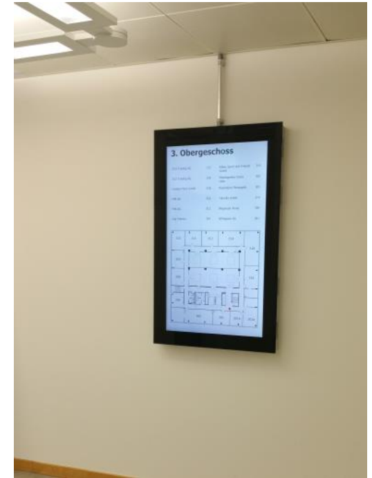
H-Type mit 49" screen wall mounting
